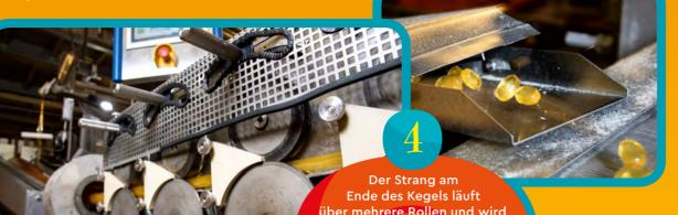
über mehrere Rollen und wird immer dünner. So erreicht er die Pressketten. PRÄGESTEMPEL von oben und unten »stanzen« die Bonbons aus - bis zu 4200 Stück pro Minute!
